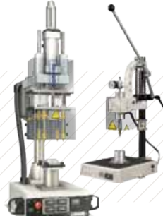
Technologie d'installation des inserts filetés
