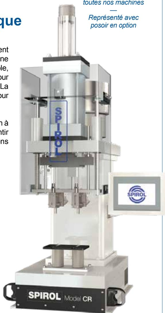
**Le modèle CR est immédiatement disponible en version double ou triple pour répondre à vos besoins d'assemblage. Des équipements en option - système rotatif d'indexation des pièces, détecteur de présence des goupilles, système de contrôle de la force d'insertion, système combinant le perçage et le goupillage - peuvent être ajoutés pour améliorer la productivité de la machine et le contrôle-qualité.**
