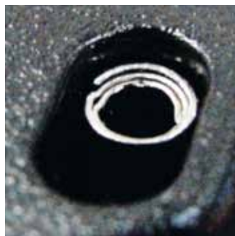
Figure 4. Utiliser un mauvais embout provoque le télescopage de la goupille.
