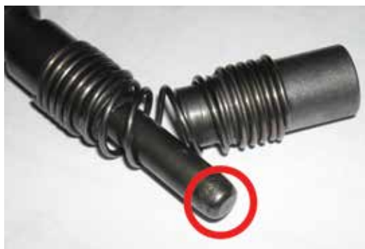
Figure 3. Embout d'insertion usé.
