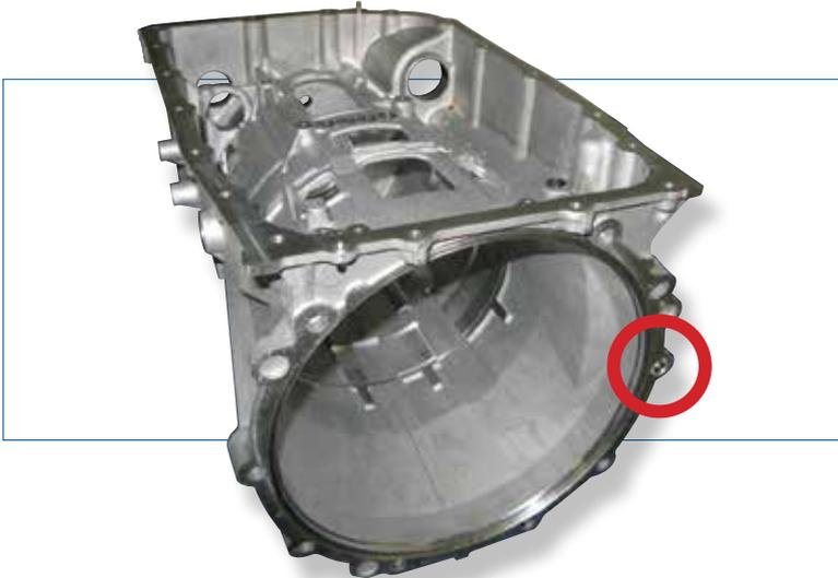
Un équipementier utilisait une goupille pleine de diamètre Ø16 mm pour positionner la transmission à l'arrière d'un moteur. Cette application était particulièrement exigeante en raison du poids des deux composants à aligner et de leur méthode d'assemblage. Le client a consulté **SPIROL** pour obtenir des suggestions de réduction de coûts.
