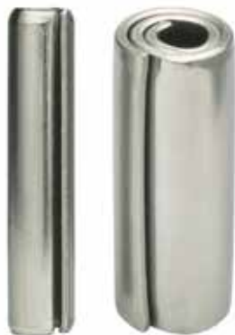
Figure 1. À gauche, les goupilles à ressort fendues ont une forme de « C ». À droite, les goupilles à ressort spiralées ont 2 ¼ de bobines de matériau enroulé.
