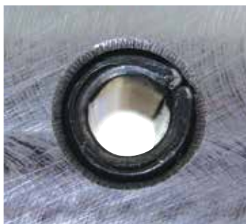
Figure 2. La fente de la goupille fendue est fermée lorsqu'elle est installée dans un trou.
