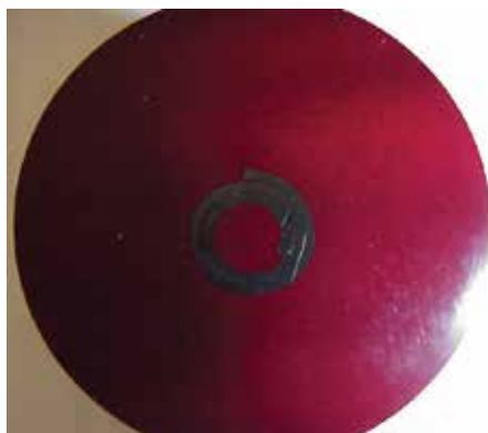
*Photographie d'une goupille à ressort spiralée montée et polie.
