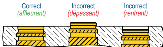
Le haut de l'insert doit être installé le plus affleurant possible de la surface de la pièce plastique.
