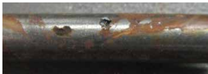
Figure 7 : Piqûres et taches sur une goupille fendue en acier inoxydable 420.
