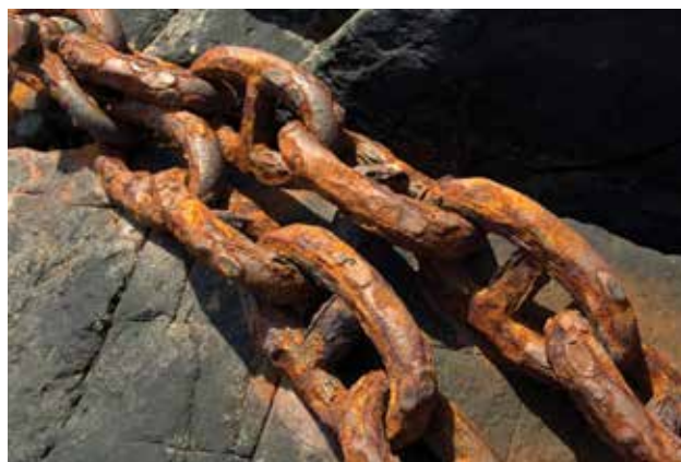
Figure 1. Une chaîne rouillée montre la perte de matériau due à la rouille ou à une attaque générale.
