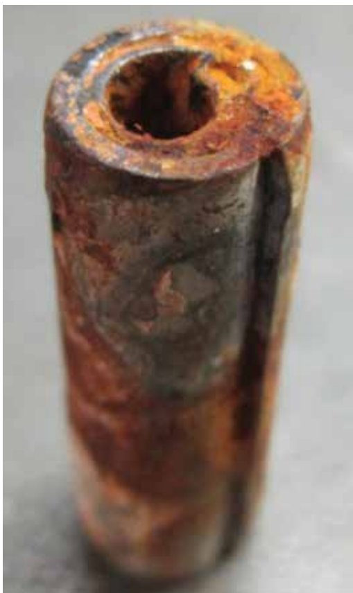
Figure 3 : Cette photographie illustre la géométrie de base d'une goupille spiralée - elle est constituée d'un certain nombre d'enroulements métalliques. Les plaques ne pénètrent pas entre les enveloppes et les revêtements par immersion, bien qu'ils soient capables de couvrir l'intérieur, restent en place.
