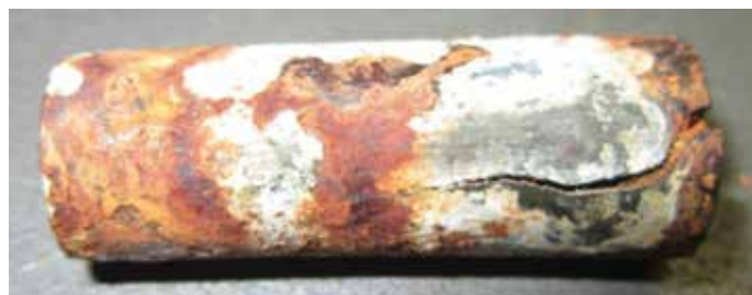
Figure 2 : Cette goupille spiralée a été finie par un zingage léger suivi d'un trempage au chromate. La finition a été évaluée pendant 48 heures pour une protection contre la corrosion « rouge ». Le fait de laisser cet article dans un brouillard salin pendant 200 heures a entraîné une rouille rouge importante, bien qu'il reste un peu de zinc et de corrosion blanche. Là où le zinc est présent en surface, la pièce reste exempte de rouille rouge malgré la gravité de l'attaque dans les zones adjacentes.
