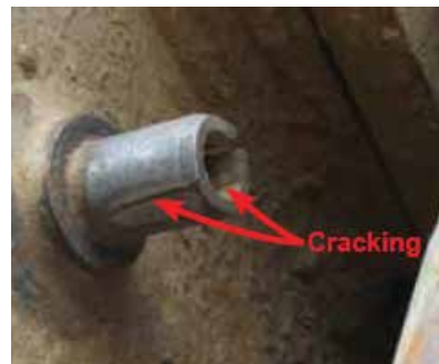
Figure 3. une goupille élastique fendue est seulement flexible sur une zone linéaire située à 180° à l'opposé de la fente
