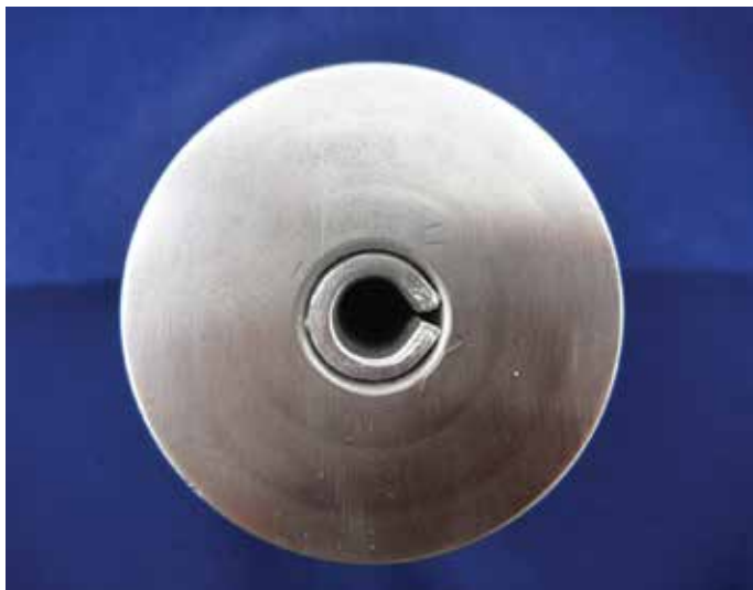
Figure 5. goupille élastique fendue installée dans un logement nominal préconisé. Notons que la fente est virtuellement fermée sur le diamètre intérieur de la goupille.
