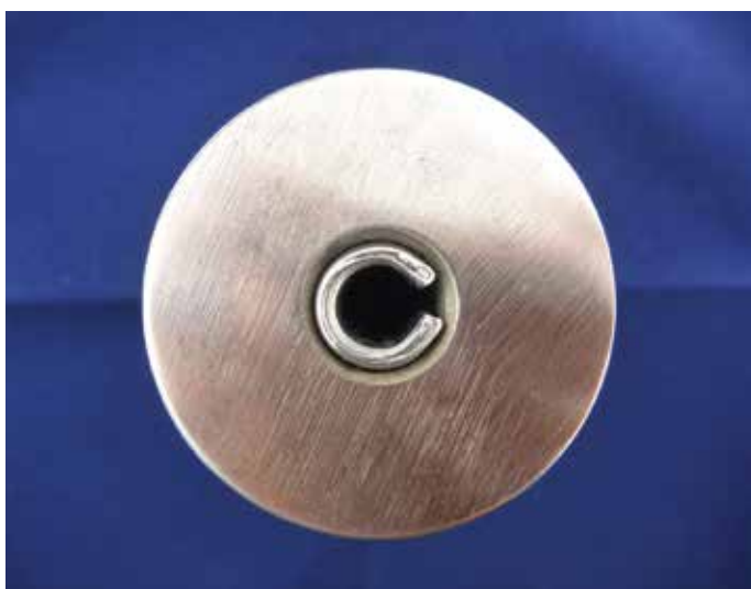
Figure 6. goupille élastique fendue installée dans un logement surdimensionné.
