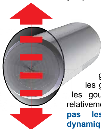
La rigidité de la goupille pleine allonge le trou.
