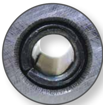
La goupille flexible fendue ne peut pas fléchir lorsque la fente est fermée.
