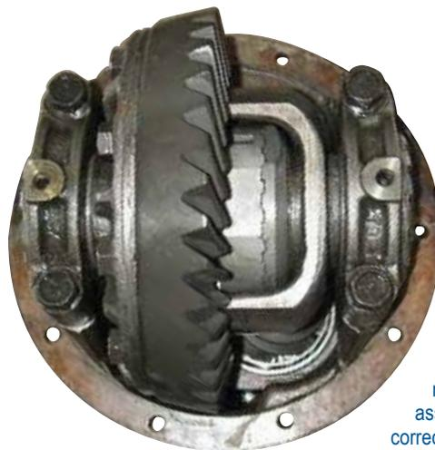
La précharge est essentielle pour assurer le bon fonctionnement et le cycle de vie prolongé d'un roulement. Les packs, ou jeux, de cales, sont utilisés pour précharger et positionner les roulements de sorte à assurer un engrènement correct des dents d'engrenages.
