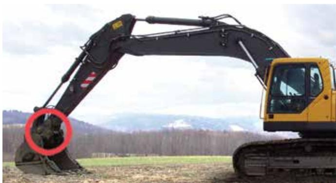
essentielles à la productivité d'un chantier de construction. Si un coupleur ne fonctionne pas correctement, les temps d'arrêt qui en résultent sont très coûteux. La sécurité du chantier dépend également des performances du coupleur. Si un coupleur se libère involontairement, la chute d'un accessoire peut causer des blessures graves.
